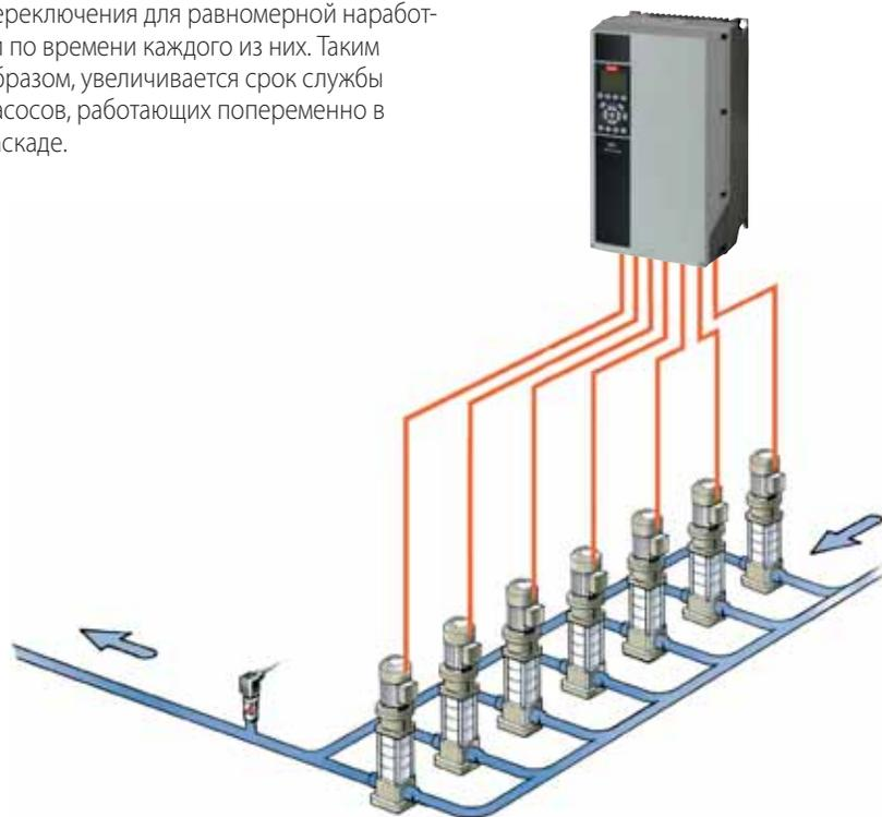
Когда насос находится в работе, то энергопотребление обычно напрямую зависит от скорости его вращения согласно характеристике, вид которой определяется исходя из конструкции насоса и системы.
