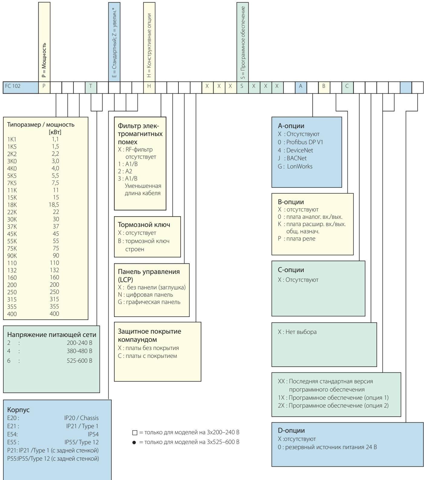
С помощью данной системы Вы легко можете подобрать преобразователь частоты VLT® HVAC Drive необходимой Вам конфигурации. Любому сочетанию модели преобразователя частоты и используемых с ним опций соответствует уникальный заказной номер.
